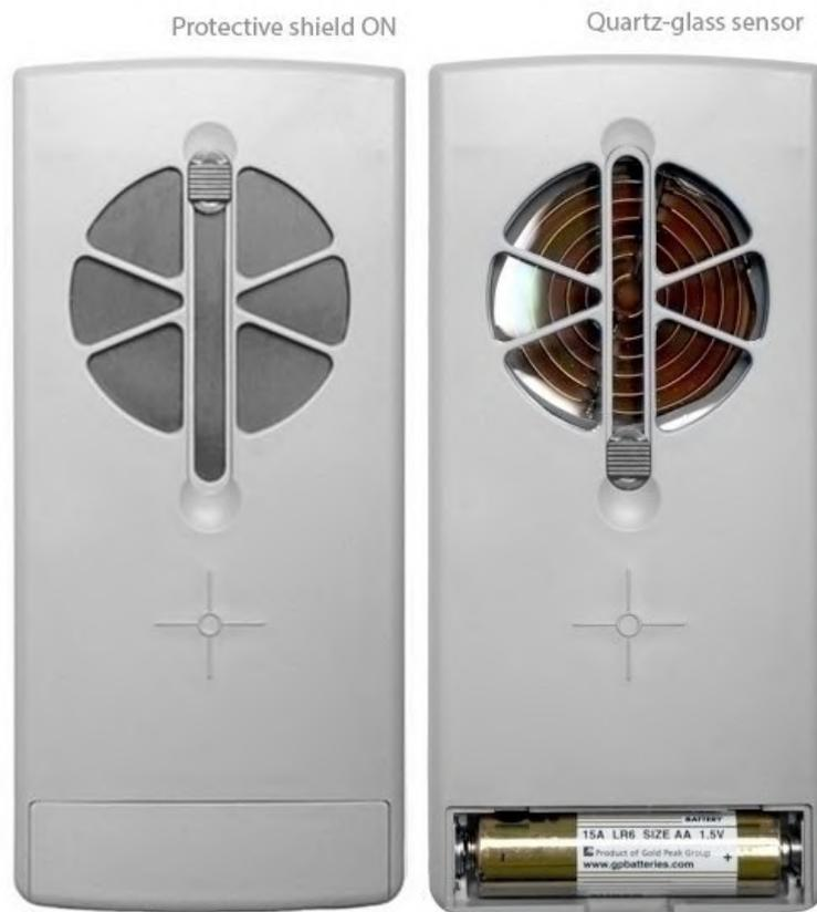
*Mit dem „Protective Shield“ wird der Sensor resp. dessen Glimmerfenster vor mechanischer Beschädigung und Verschmutzung geschützt. Das Schutzfenster muss vor jeder Beta/Alpha Messung nach unten geschoben werden.*
