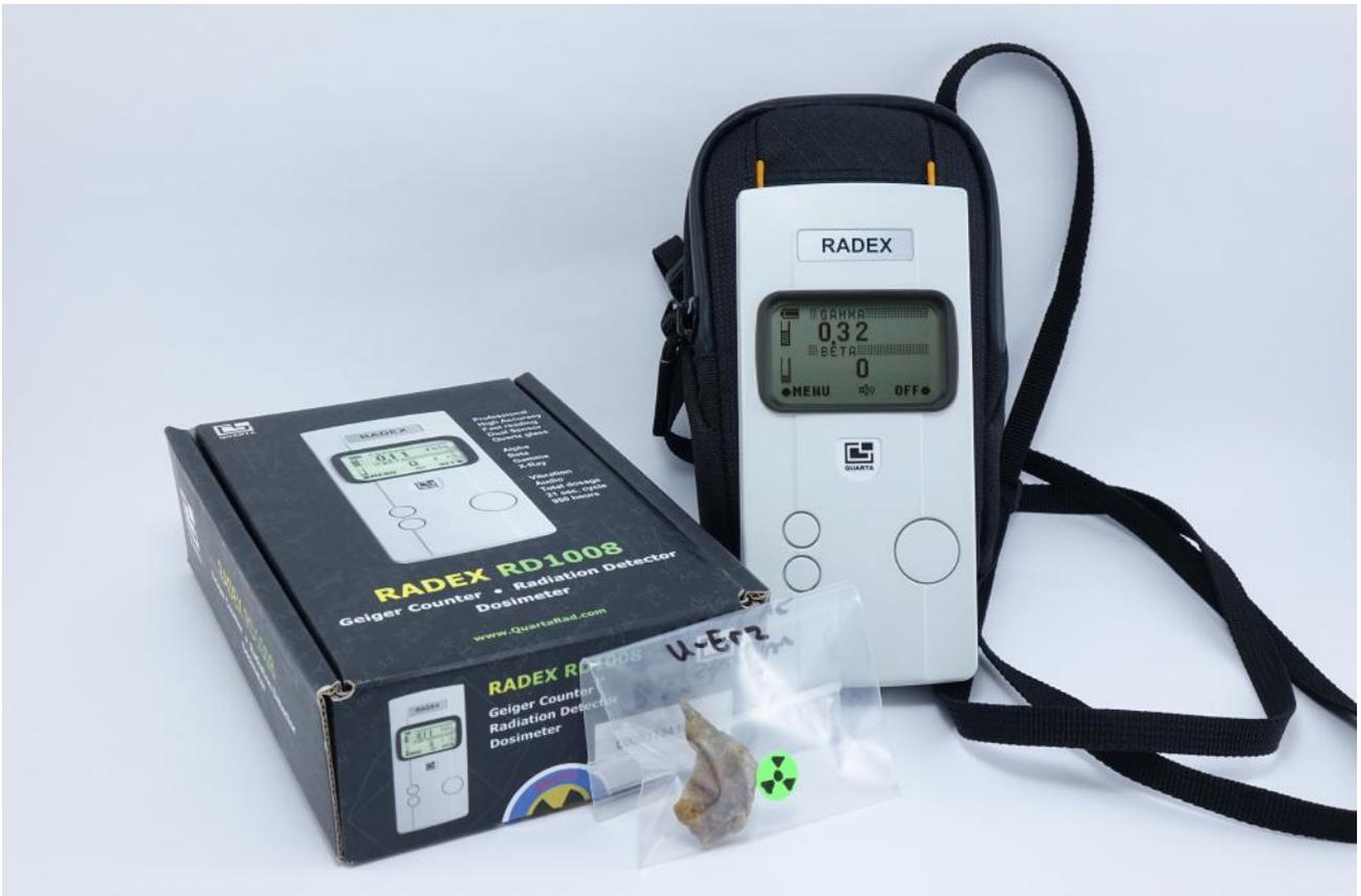
Im Bild oben läuft der RD1008 im MEASURE Modus, Anzeige in  $\mu\text{Sv/h}$  und  $\text{CPM}/\text{cm}^2$
