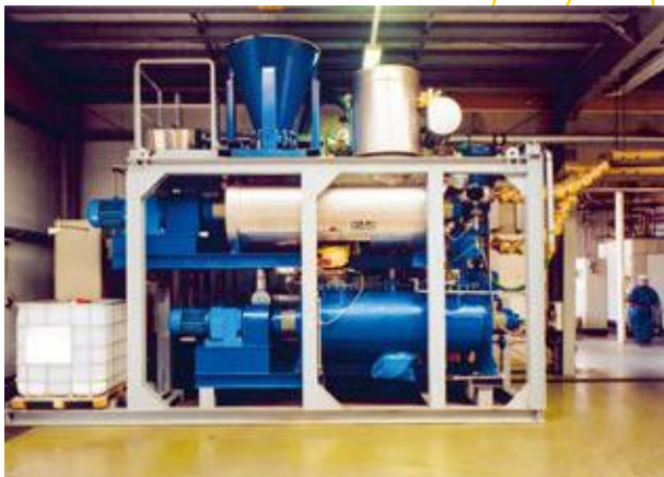
Anlage zur Quecksilbergewinnung aus Rückständen der Erdgasindustrie
