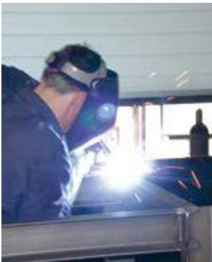
Schweißen mit thoriumhaltigen Schweißelektroden
