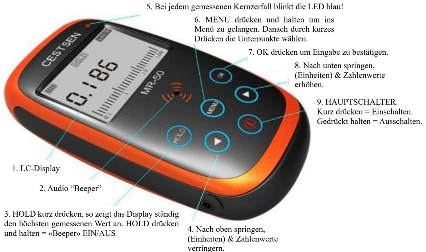
Der Messwert wird auf dem Display (1) angezeigt. Bitte verwenden Sie den Schalter (4) oder (8) um die Einheit (uSv/h, mR/h, CPM, Total) zu wählen. Total = fortlaufende Aufsummierung der gemessenen Zerfälle.
