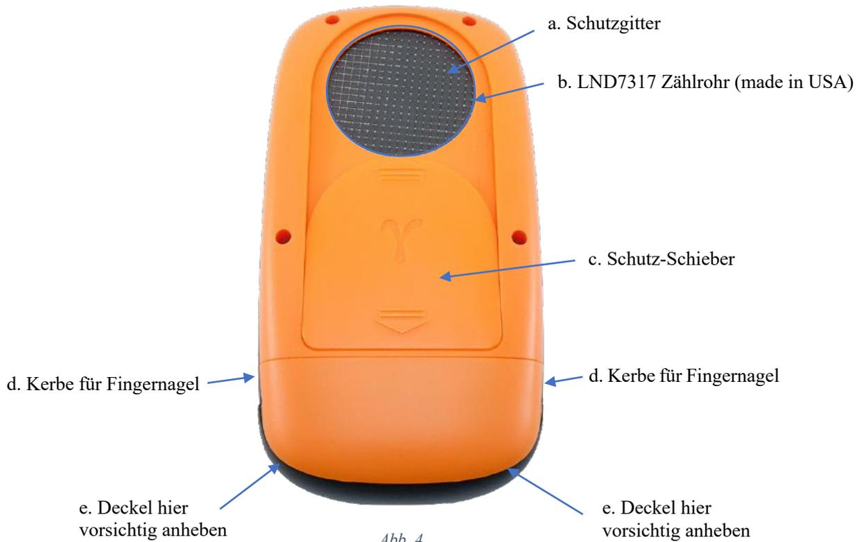
**Bei offenem Y-Schieber der MR-50 misst  $\alpha$ ,  $\beta$ ,  $\gamma$  and X-Strahlung**
